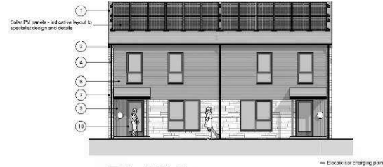
4 Drychiad01_Blaen Elevation01_Front Elewacja01_Przód Scale: 1 : 100
