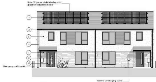
4 Drychiad01_Blaen Elevation01_Front Elewacja01_Przód Scale: 1:100
